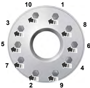
10-lug nut torque sequence
